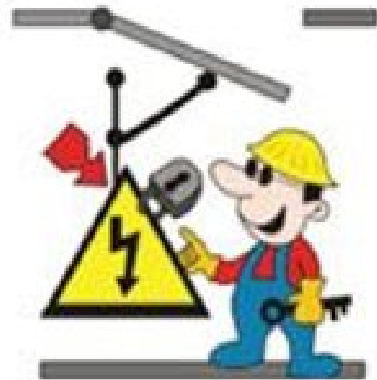
Bloqueo o enclavamiento de los aparatos de corte
