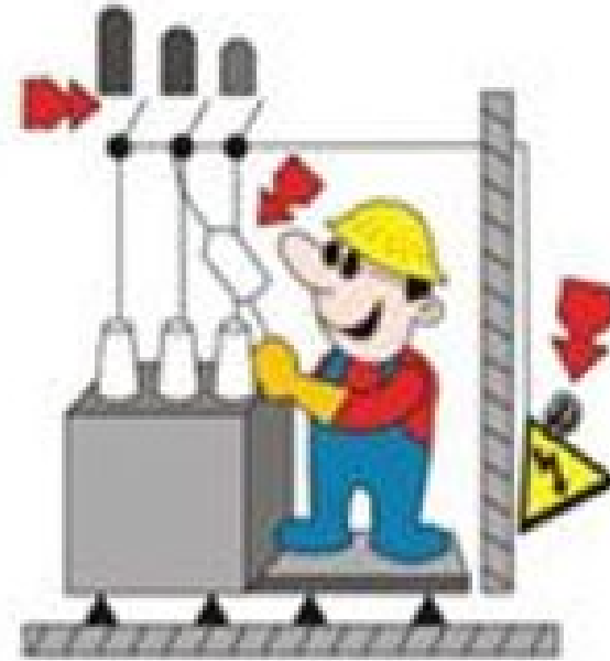
Detectar ausencia de tensión
